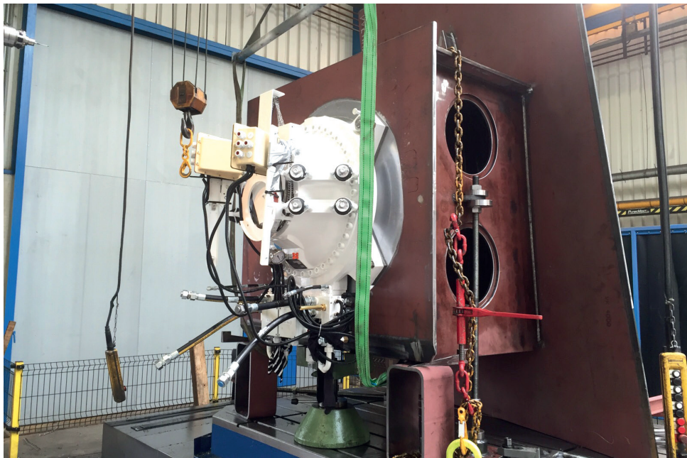
Stuwa superjacht roerfundatie op kottterbank bij De Waal met roteryvane stuurmachine.
