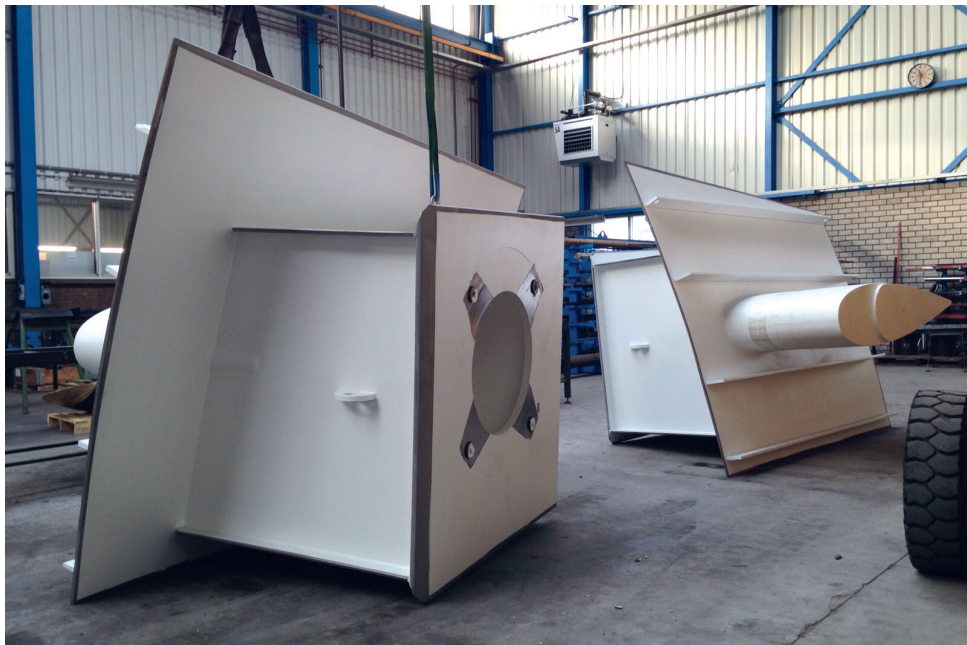
Superjacht roerfundatie inclusief hennekoker, uitgevoerd in roerprofiel, gereed voor transport naar jachtwerf.
